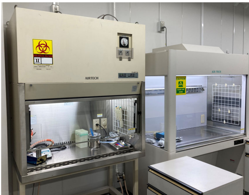
ランクセス川崎テクニカルセンターのラボ装置。安全キャビネット(左)クリーンベンチ(右) (写真:ランクセス)
