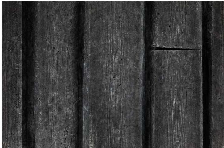
ランクセスの「バイフェロックス」黒色酸化鉄顔料で着色されたコンクリートは、経年変化した木材の風合いを再現しています。(写真提供:ランクセス AG)
