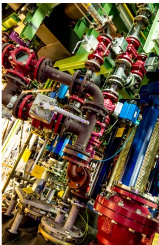
12 立方メートルの反応器の供給ライン。レバクーゼンにあるサルティゴの中央有機合成パイロットプラントにて。(写真:サルティゴ GmbH)
