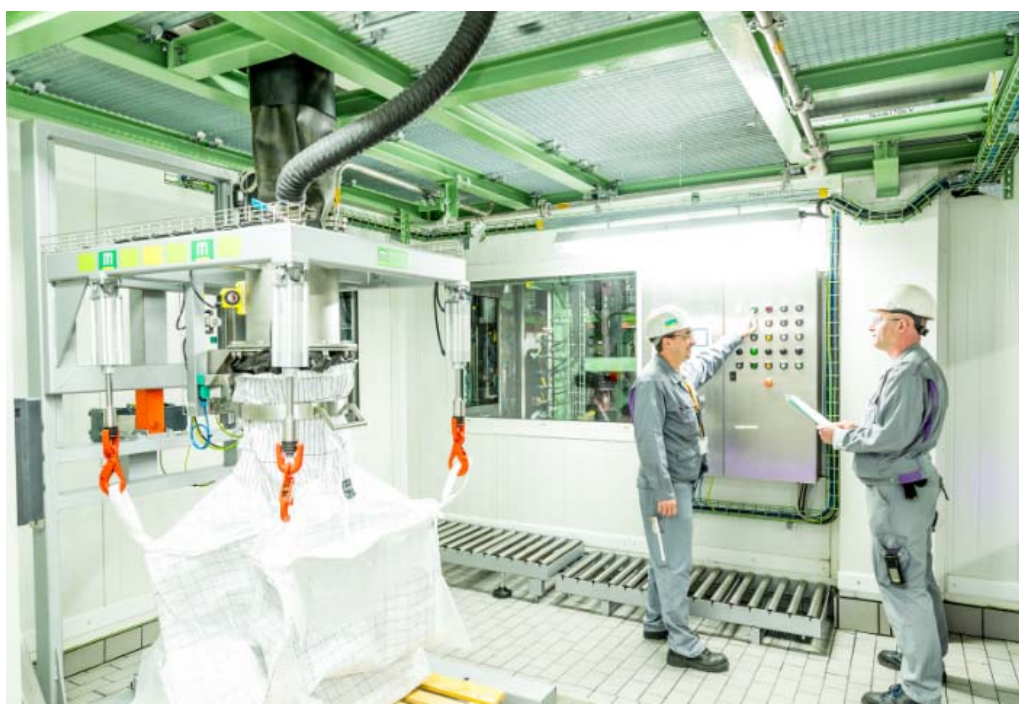
中間体と活性成分を大型バッグに充填(写真:サルティゴ GmbH)
